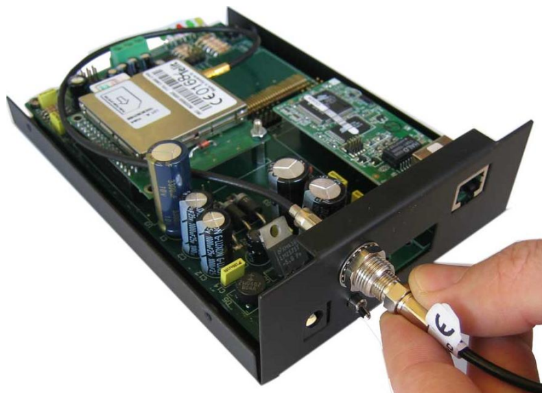
Connessione antenna GSM
