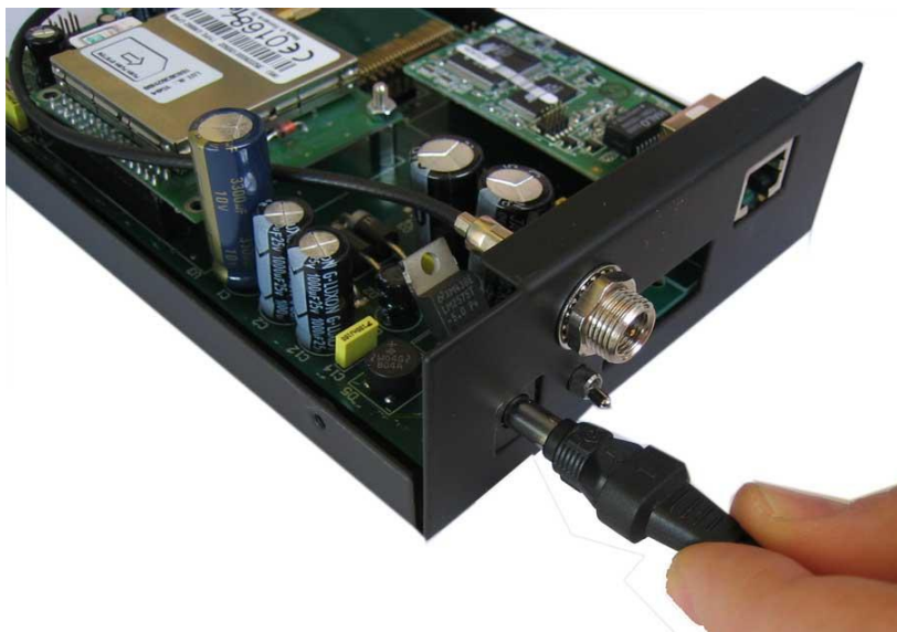
Connessione dell'alimentatore
