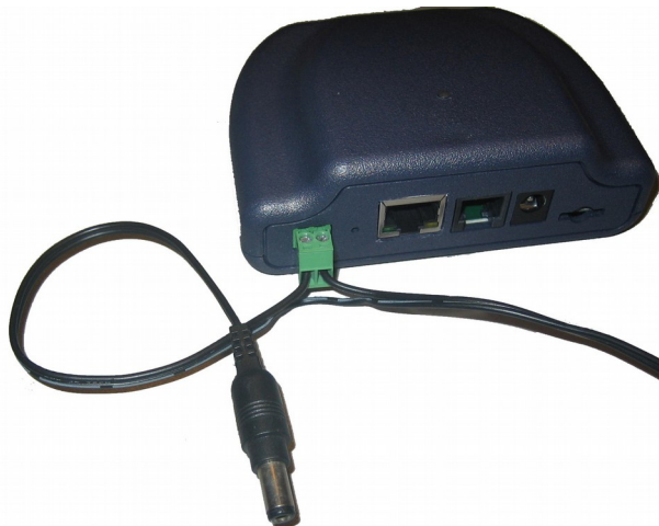
Immagine 4 – Collegamento del relè
