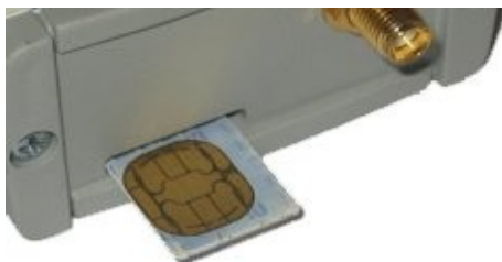
Immagine 6 – inserimento carta SIM nel modem
