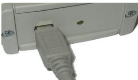
Immagine 7 – inserimento connettore mini-B
